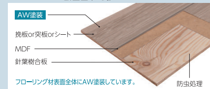
■ フローリング断面図 (一例)
